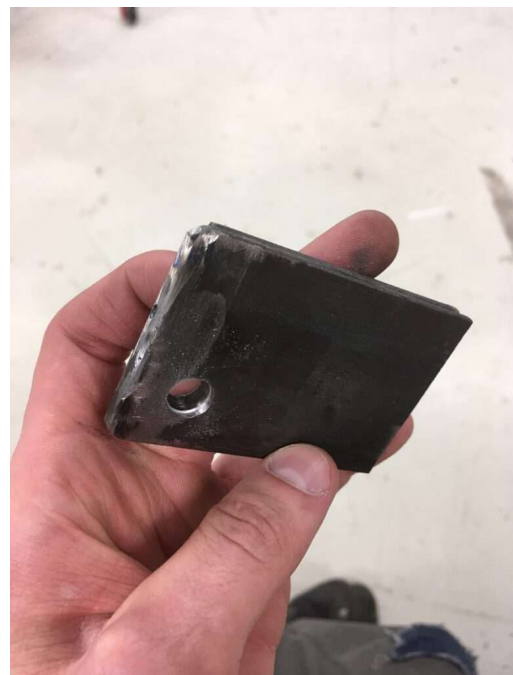
Lattarautaa hitsattiin yhteen ja porattiin reikä, reikään tehtiin kierteet, jotka menivät hieman vinoon.
