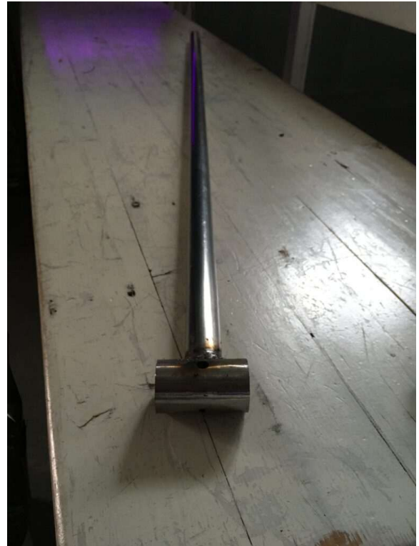
Irtonaiseen keskiöputkeen hitsattiin kaveriksi 30 mm huonekaluputkea.
