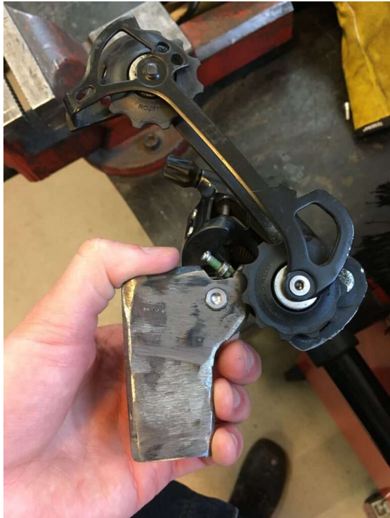
Korvake tehtiin hybridipyörän takavaihtajankorvakkeen mittojen mukaan.
