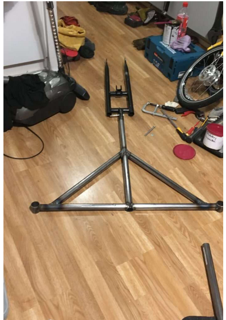
Tässä on yhdistetty takahaarukka pultilla pohjakolmioon, johon on hitsattu emäputket.
