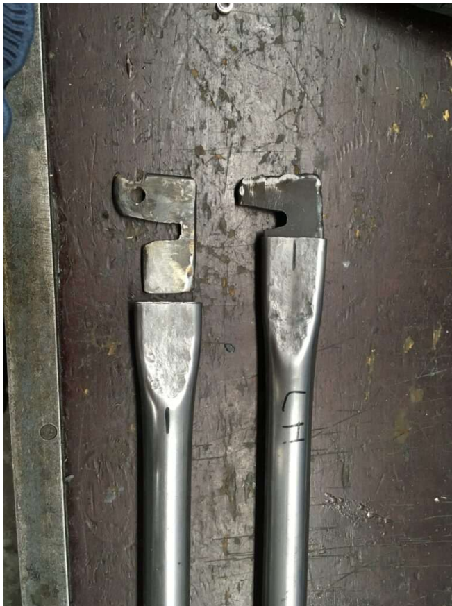
Korvakkeeseen sahattiin akselin mentävä lovi. Takahaarukka tehtiin pyöreästä huonekaluputkesta, joka taottiin tiukaksi.
