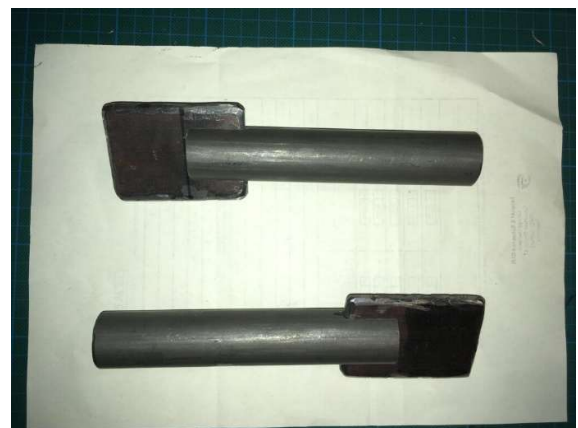
Ohjainputket tehtiin Briteistä tuodusta tuumakokoisesta putkesta. Putkeen sahattiin lovi akseliin kiinnittyvää lattaa varten.
